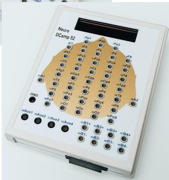
52/36 チャンネルDCデジタル多用途脳波計 **Neuro-DCamp** は、脳波・筋電図・心電図・眼球運動・脳誘発電位などの生体電気信号の計測を目的とする、低ノイズDCデジタル生体信号増幅器です。各チャンネル毎にフィルターを設定でき、外部刺激 8 BIT 及び外部アナログ信号 4 チャンネルを有しています。またオプションで、3 軸加速度計・呼吸センサ・GSRセンサ・指尖脈波センサ・光トリガ入力装置及び音刺激入力装置をご用意しております。
