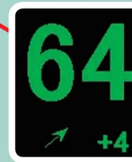
TOI(%)表示の下部に示された矢印と変化値表示で、測定開始時からの変化が一目でわかります。
